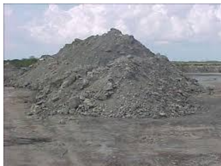
Gambar 2. Abu Terbang Batubara ( Fly Ash )
