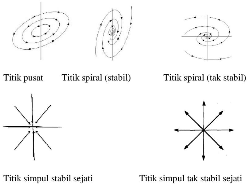
**Gambar 2. Kriteria kestabilan dari titik tetap ditinjau dari cara orbit mendekati atau menjauhi titik tetap**
