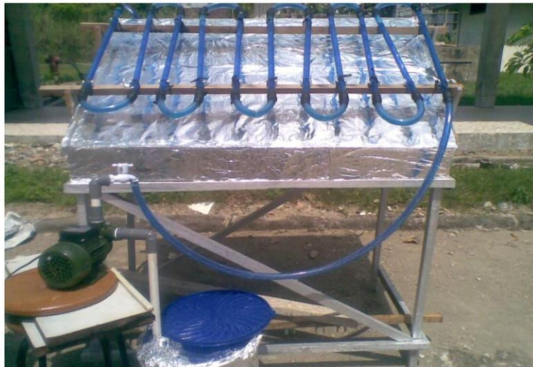
Gambar 3. Reaktor Fotokatalitik TiO<sub>2</sub>/SiO<sub>2</sub>
