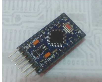
Gambar 1. Bentuk fisik Mikrokontroler Arduino (dokumentasi)
