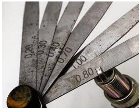
Gambar 2. Celah Kerenggangan Dari Busi ( http://www.mechaniconlines.com )
