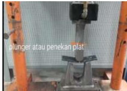
**Gambar 21.** Plunger (bagian yang menekan benda uji)
