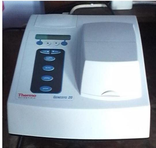
Gambar 4. Spektrofotometer Visibel
