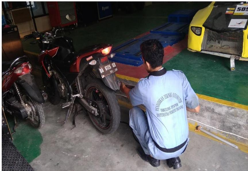
**Gambar. Pengujian kendaraan menggunakan *fourgas analyzer***
