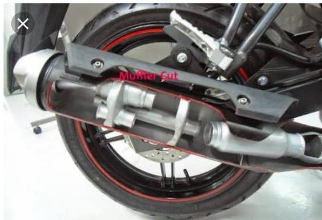
**Gambar 5:** *Muffler Cut* Knalpot New Vixion Advance
