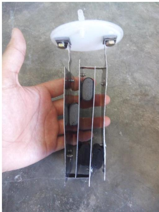
**Gambar 7.** Plat Elektroda yang Terpasang pada Tutup Botol
