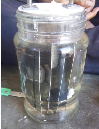
**Gambar 8.** Alat *Electrolyzer*
