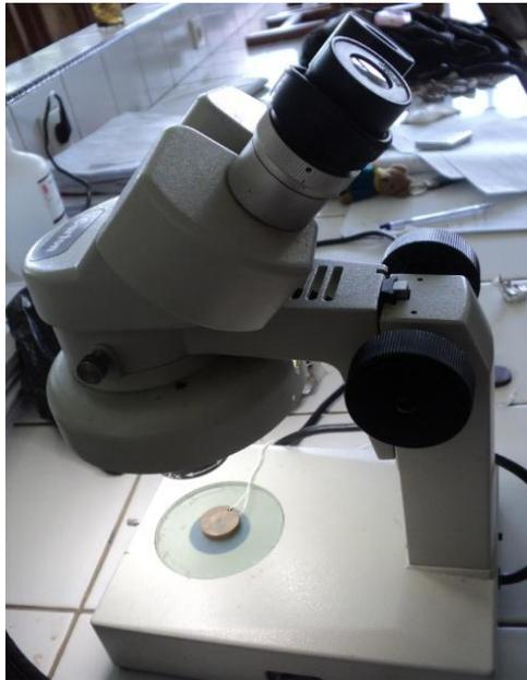
Gambar 5. Mikroskop Stereo Binokuler Carton tipe FCL 9EX-N 9 W
