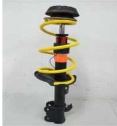
Gambar 7. *Regenerative Shock Absorber* Toyota Avanza bagian depan.
