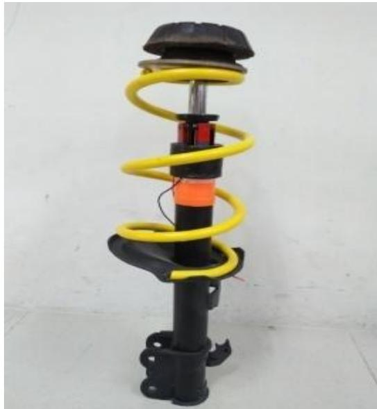
Gambar 17. *Regenerative Shock Absorber* Toyota Avanza bagian depan.
