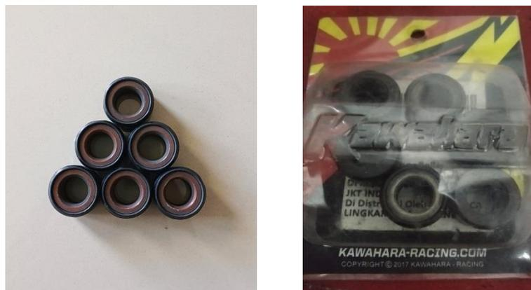
Gambar 5. *Roller* Standar 15 g dan *Roller Racing*( 7 g, 8 g dan 9 g )
