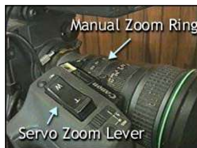
Gambar 2. Panel Zoom Pada Kamera Sumber: Sri Waluyanti(2008: 526)
