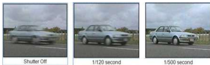
Gambar 5. Fungsi Shutter Pada Kamera Sumber: Sri Waluyanti(2008: 535)
