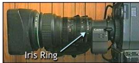
Gambar 4. Ring Pengatur Iris Kamera Sumber: Sri Waluyanti(2008: 527)
