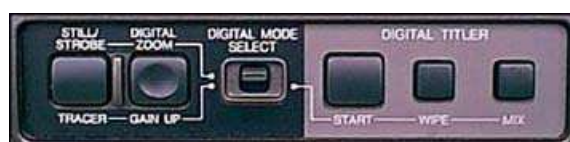
Gambar 6. Tombol Effect Pada Kamera Sumber: Sri Waluyanti(2008: 529)
