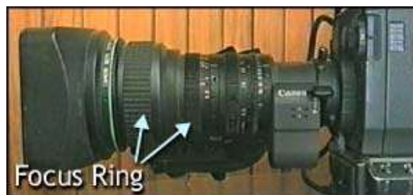
Gambar 3. Ring Pengatur Fokus Pada Kamera Sumber: Sri Waluyanti(2008: 526)
