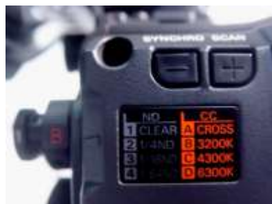
Gambar 14. Selector Penggunaan Suhu Warna pada Kamera Video Sumber: Ming Muslimin (2013: 34)
