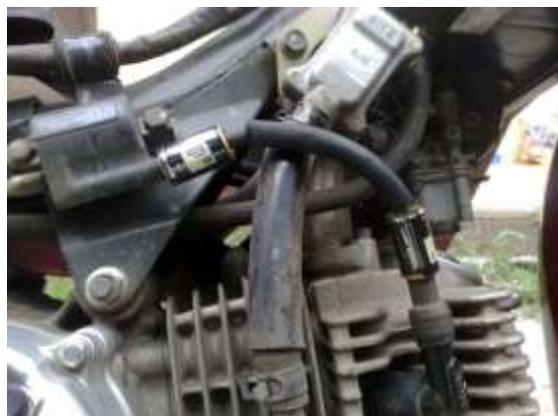
Gambar 11. Pemasangan 2 buah 9-Power
