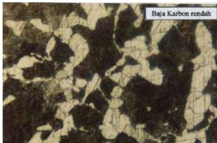
Gambar 3. Struktur Mikro Baja Karbon Rendah
