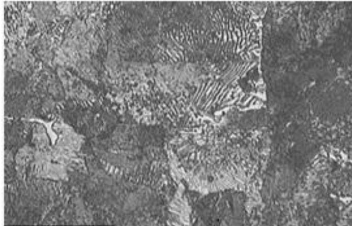
Gambar 5. Struktur Mikro Baja Karbon Tinggi
