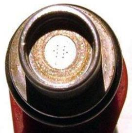
Gambar 3. Injektor 10 lubang
