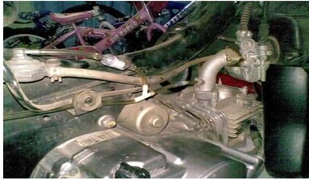
**Gambar 4.** *Water injection* pada motor konvensional
