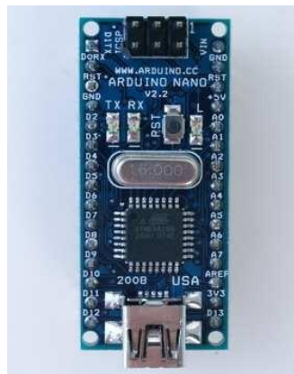
Gambar 9. Arduino Nano dan Mini Sumber : Feri Djuandi (2011)
