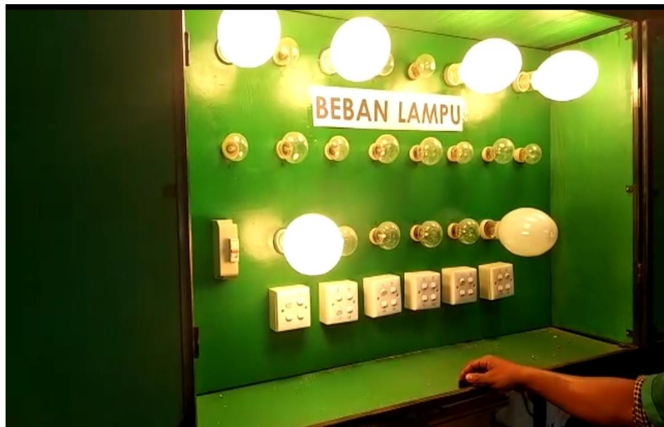
Gambar 4. Alat Pengujian Kinerja Motor Diesel Lampu Dengan Indikator Ampermeter
