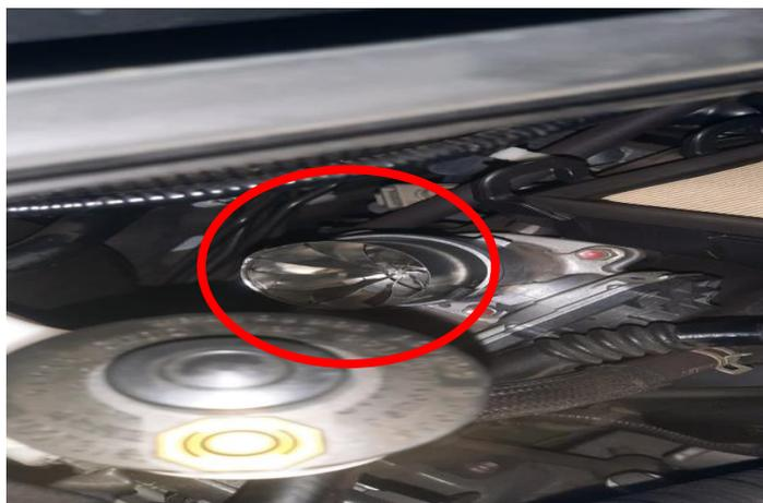
Gambar 14. Pemasangan *double turbo cyclone* pada *throttle body*
