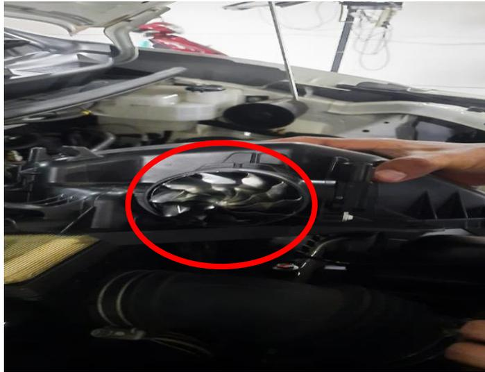
Gambar 13. Pemasangan *double turbo cyclone* pada *box air filter*
