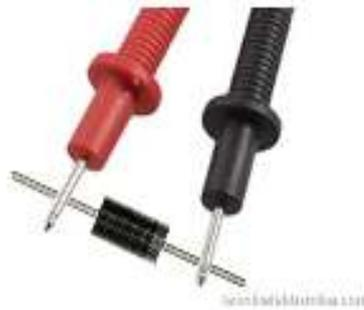
Gambar 9. Bentuk Dioda
