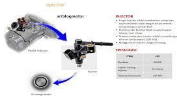
Gambar 3. Kontruksi Injektor jupiter Z1 Sumber : Gridoto.com
