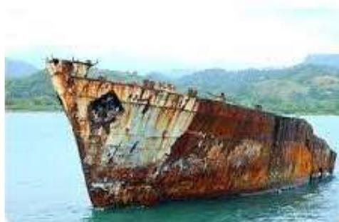
Gambar 9 bangkai kapal di dasar laut yang telah terkorosi oleh kandungan garam yang tinggi.
