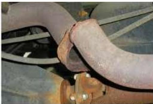
Gambar 8 Knalpot kendaraan bermotor yang mudah terkorosi akibat temperatur tinggi.
