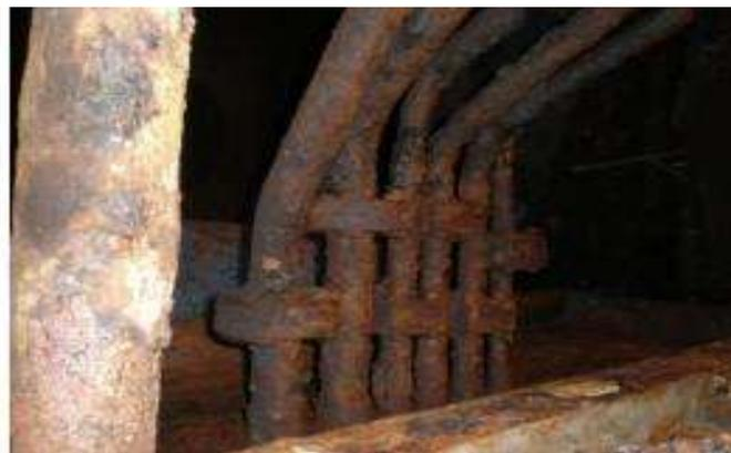
Gambar 1 Korosi Seragam pada pipa ballast (Utomo, 2009)
