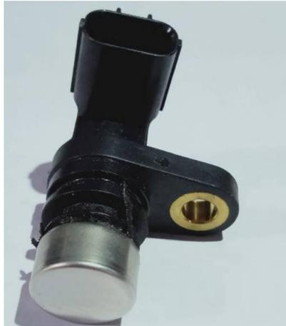
Gambar 2. Sensor kecepatan Motor Honda Scoopy
