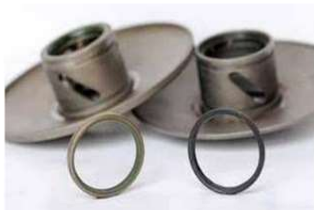
Gambar 6. Secondary Sliding Sheave Sumber: Teknik Sepeda Motor
