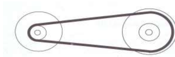
Gambar 10. Posisi V-belt saat mulai berjalan (Sumber : Yamin, Dkk, 2009 : 4)
