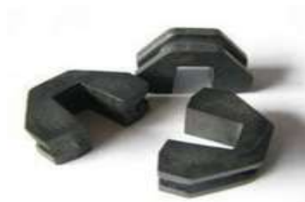
Gambar 4. Plastic slider guide Sumber: Teknik Sepeda Motor
