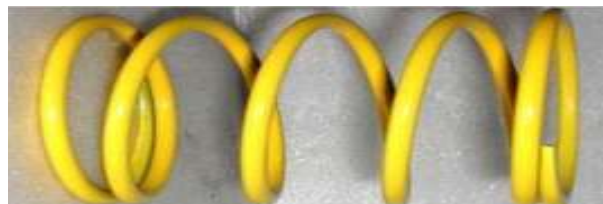
Gambar 7. Pegas CVT Sumber: Teknik Sepeda Motor
