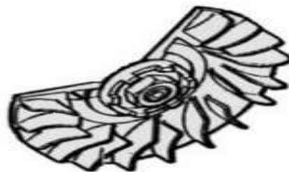
Gambar 2. Primary fixed sheave dengan sirip pendingin Sumber: Teknik Sepeda Motor
