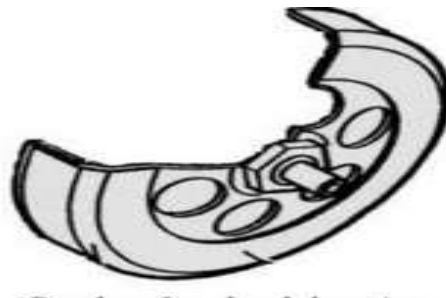
Gambar 8. Rumah Kopling Sumber: Teknik Sepeda Motor
