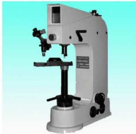
**Gambar 2. Alat uji kekerasan**
