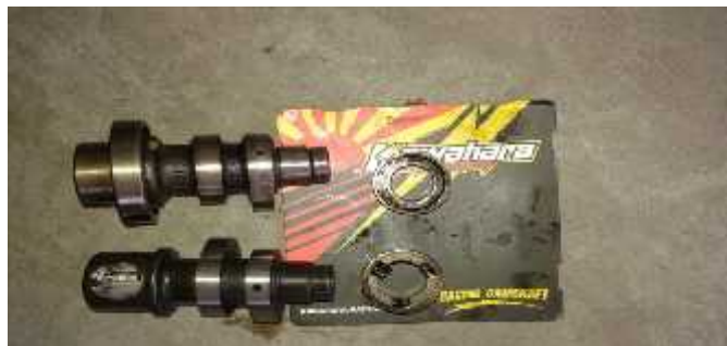
Gambar 1. Camshaft standard dan camshaft racing (Sumber : Dokumentasi penulis)
