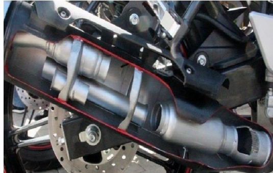
Gambar 4 : Muffler (Sumber : motogokil.com )
