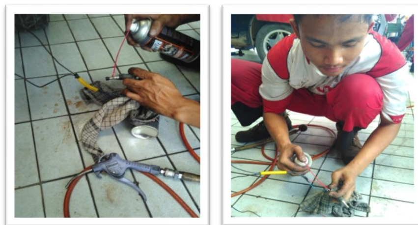
Gambar 2. Membersihkan Injektor dengan Metode Manual. (Sumber : Laporan Praktek Lapangan Industri Rahmat Hidayat)
