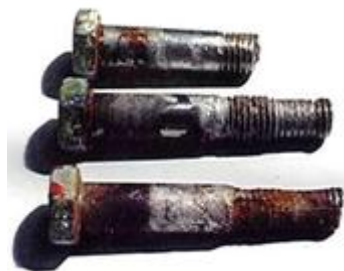
Gambar 5. Korosi Celah Sumber: mechanicallengboy.wordpress.com
