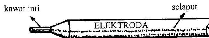
Gambar 6. Contoh sebuah elektroda yang terdiri atas kawat inti selaput.
