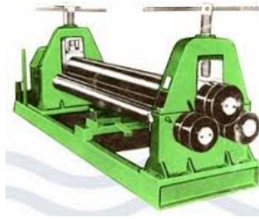
Gambar 22. Mesin bending plate manual sistem 3 roller.
