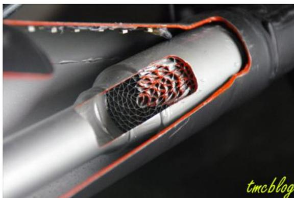
Gambar 2. Calatytic converter pada sepeda motor (tmcblog)
