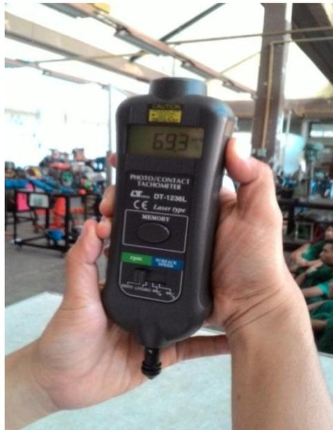
Gambar 1. RPM meter dengan sensor infra merah
