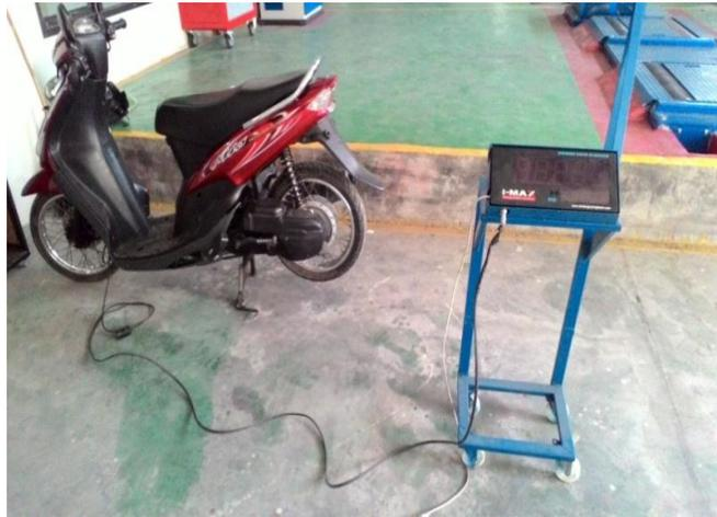
Gambar 2. Penggunaan RPM Meter I-MAX pada sepeda motor Yamaha MIO
