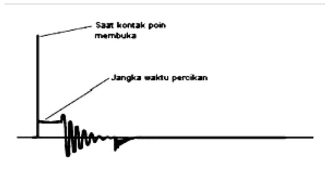
Gambar 5. Osiloskop pola bentuk gelombang sekunder tunggal (Step 2 Toyota, 1995)
