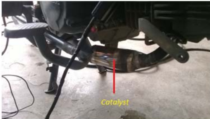
Gambar 2. Pemasangan Catalyst Pada Knalpot (Dokumentasi)
