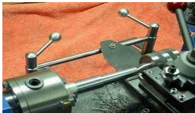
Gambar 5. Pembubutan Tirus dengan Tapper Attachment , ( Http://www.achmadarifin.com/pemesinan/3-cara-membuat-poros-tirus-denga-mesin-bubut ).
