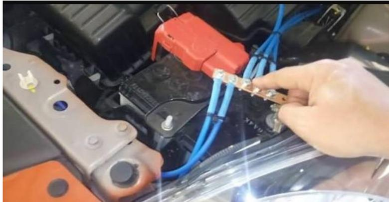
Gambar 8. Pemasangan kabel *Grounding*
