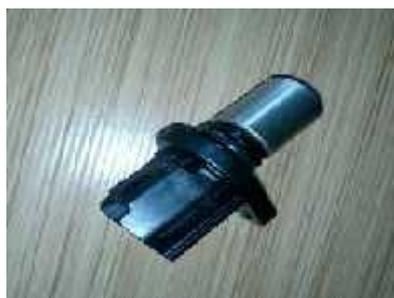
Gambar 24. Sensor Camshaft Position Sensor
