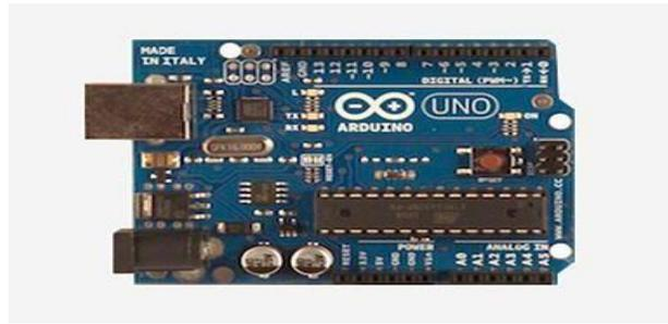
Gambar 8. Board arduino uno
