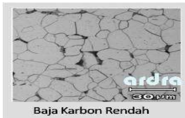
Gambar 9. Struktur Mikro Baja Karbon rendah
