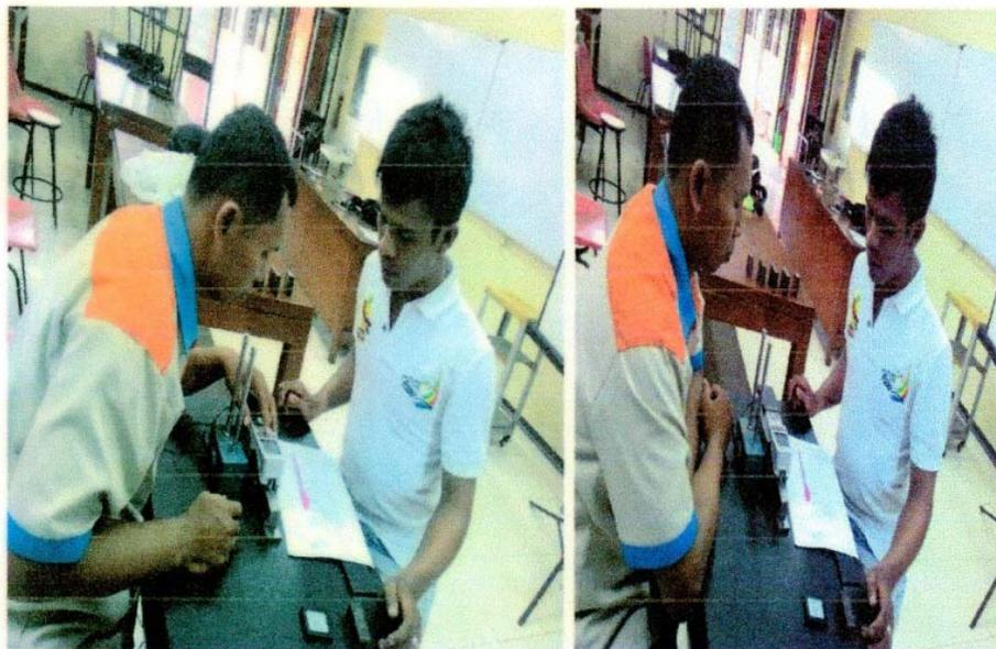
Pengukuran Luas Penampang Spesimen Sebelum Pengujian
