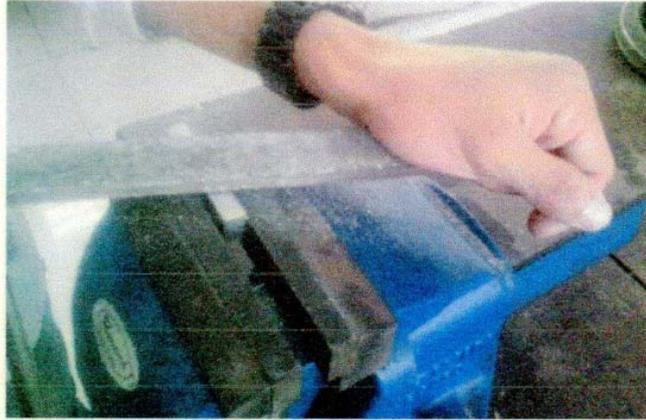
Meratakan Permukaan Setelah Pemotongan
