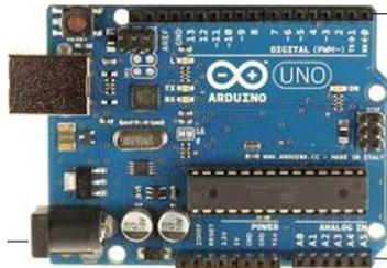
Gambar 7. Bentuk Fisik Arduino Uno
