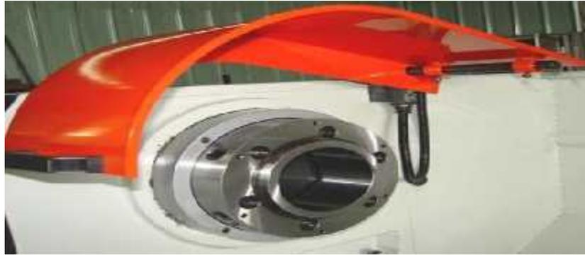
Gambar 1. Kepala tetap, tampak spindel utama mesin
