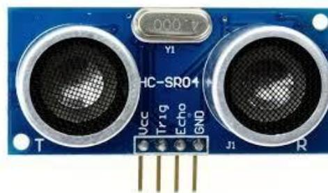
Gambar 6. Bentuk sensor HC-SR04
