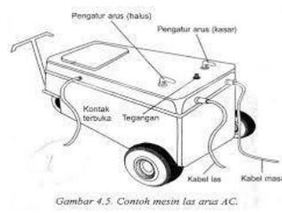
Gambar 4.5. Contoh mesin las arus AC.
