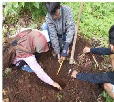
**Gambar. 33: Dokumentasi Pengukuran Kedalaman Efektif Tanah**
