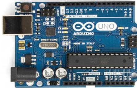
Gambar 8. Papan kerja arduino uno rev3
