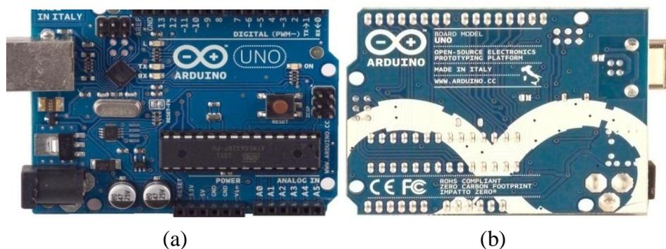
Gambar 7. Arduino Uno, (a) Tampak Depan dan (b) Tampak Belakang
